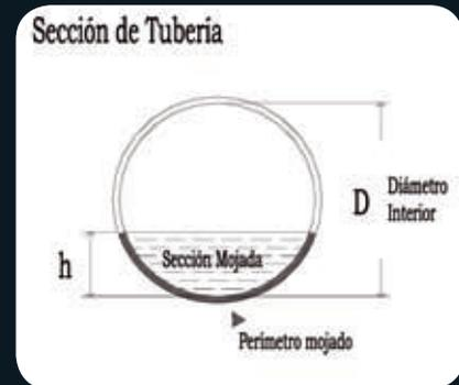
Para determinar la velocidad y el caudal de un flujo que circula en el interior de una tubería vamos a relacionar la velocidad y el caudal para un calado  $h$ , con la velocidad y el caudal a sección llena. Para ello utilizamos las tablas de THORMANN y FRANKE, que además consideran el efecto de fricción del aire ocluido con la lámina libre de agua y la pared de la tubería.
