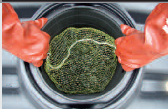
4 – Extraer el filtro indicador de colmataje integrado y al elevarlo, girar las manos hacia el exterior
