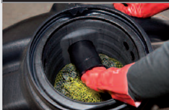
3 – Retirar el manguito reemplazable de su conexión tirando de la empuñadura
