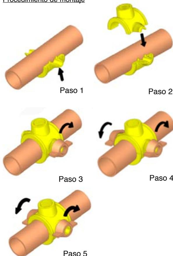
Paso 1.- Colocar la parte inferior del collarín y mantenerlo
